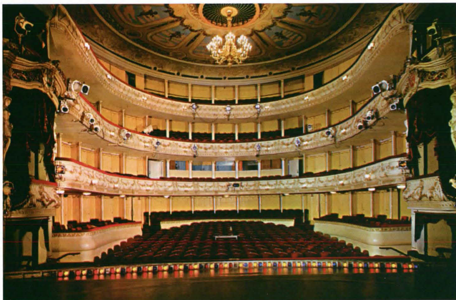
Sali ennen vuoden 1975 permannon lattiaremonttia. Kattolistan yläpuolella näkyvät seitsemän tummaa pyörölää ovat 1930-luvun rakenteisiin kätkeytyä valonheittäjiä. Muut salin puolen valaisimet ovat tulleet ensiparvelle 1964 rakennetun valo- ja ääniohjauksen myötä. SvTA.
