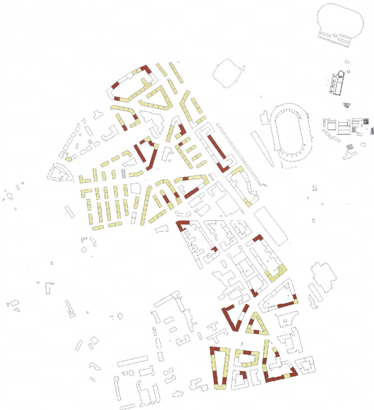
Kuva 49. Teemakartta Taka-Töölön kerrostalojen runkorakenteista. Tiilimuurirunko (tummempi väri) oli vallitseva vielä 1930-luvun alussa ja alueen eteläosissa. Vuosikymmenen loppupuolta ja alueen pohjoisosia lähestyttäessä sekarunko (vaaleampi väri) valtasi alaa.
