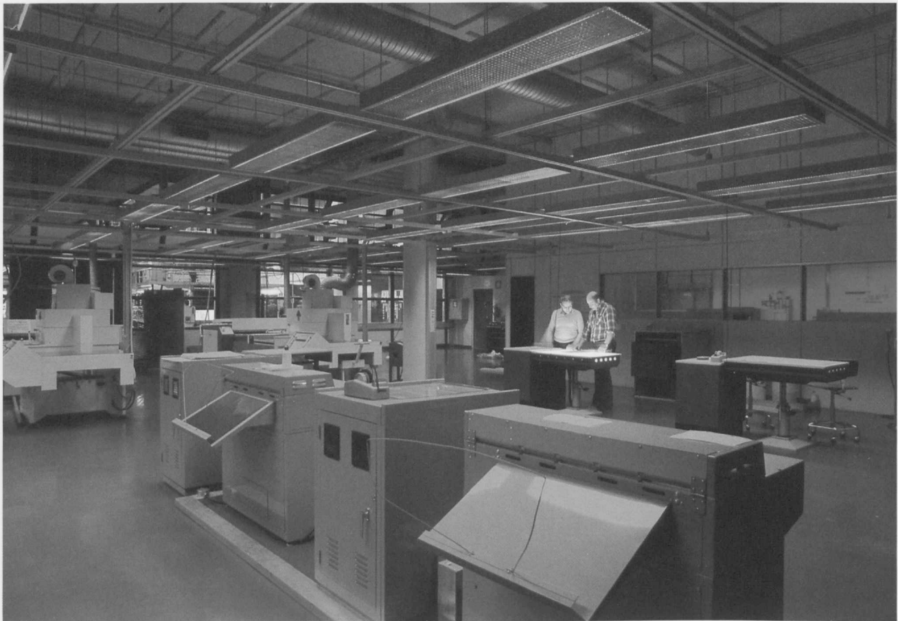
Yleisnäkymä painolevynvalmistuksesta. Etualalla on painokoneen ohjausjärjestelmään kuuluva sivun tummuuden esiasetuslaitteisto. Taustalla näkyvä punainen valo tulee Laser-sivunsiirtohuoneesta.
