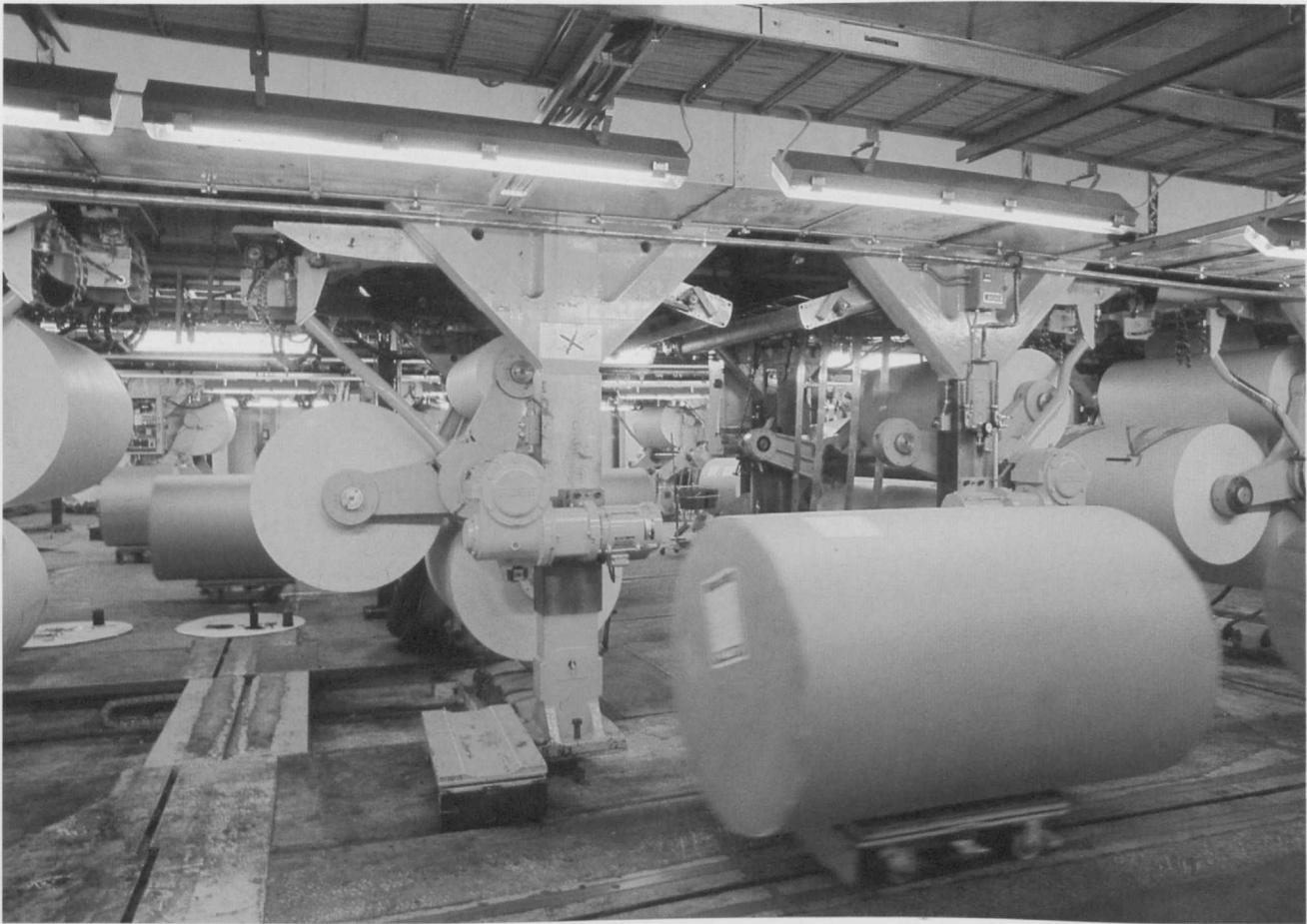
Rullataso. N. yhden tonnin painoiset rullat kulkevat kuljettimen avulla rullanvaihtajan luo; näillä rullanvaihtajilla voidaan siirtyä tyhjästä rullasta täyteen rullaan painokoneen vauhtia hiljentämättä.
