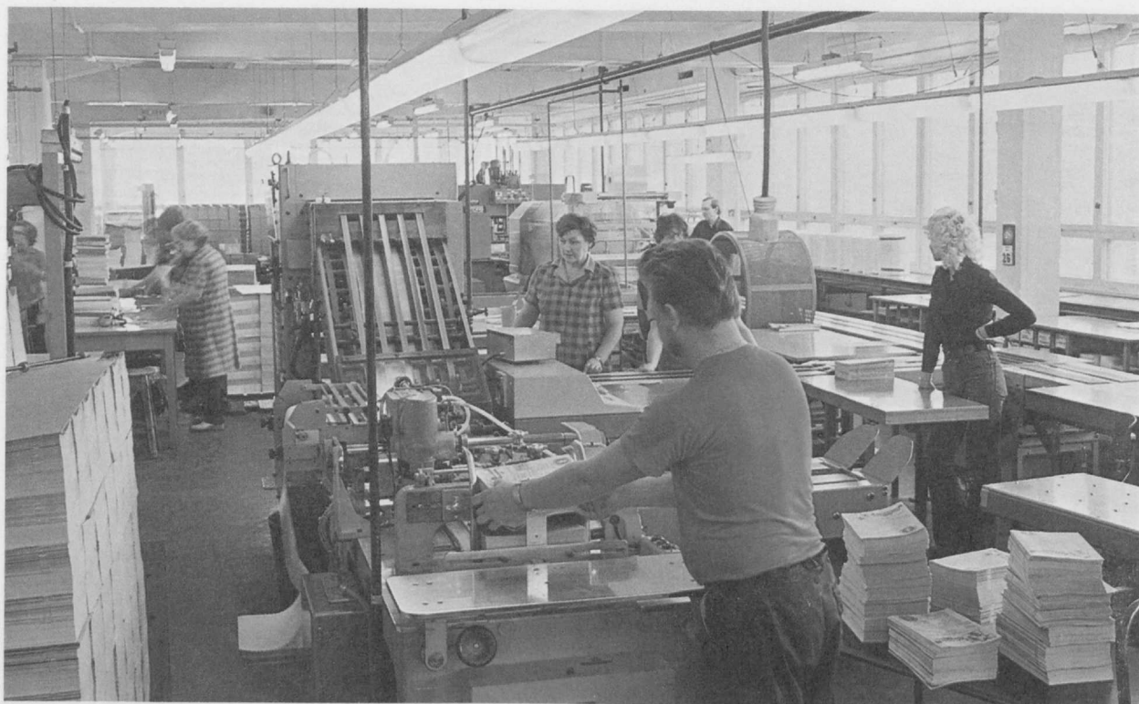
Sanomapaino sai Hiomontielle uudistetun postituslinjan. Uuteen linjaan sisältyvät paikkakuntaerottelu, kutistemuovipakkaus sekä automaattisidonta.
